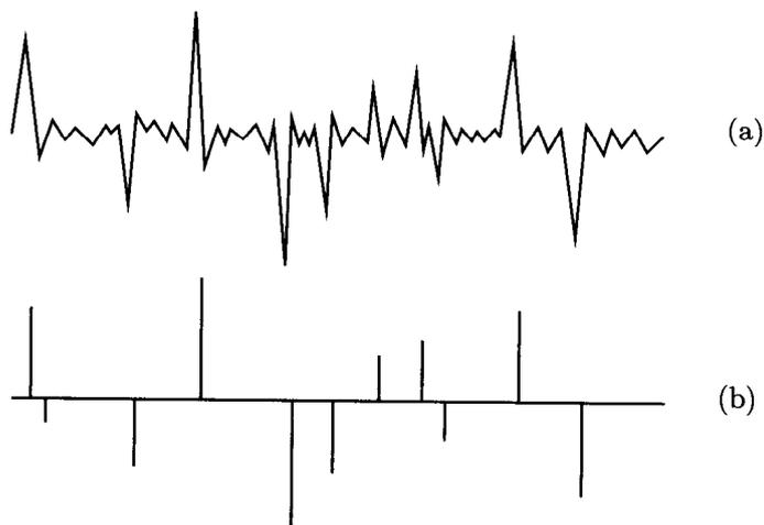
FIGURE 1 – (a) Représentation schématique de la force stochastique  $\zeta(t)$  en fonction du temps. (b)  $\zeta(t)$  approximée par une série de chocs aléatoires. © P. M. Chaikin, T. C. Lubensky.
