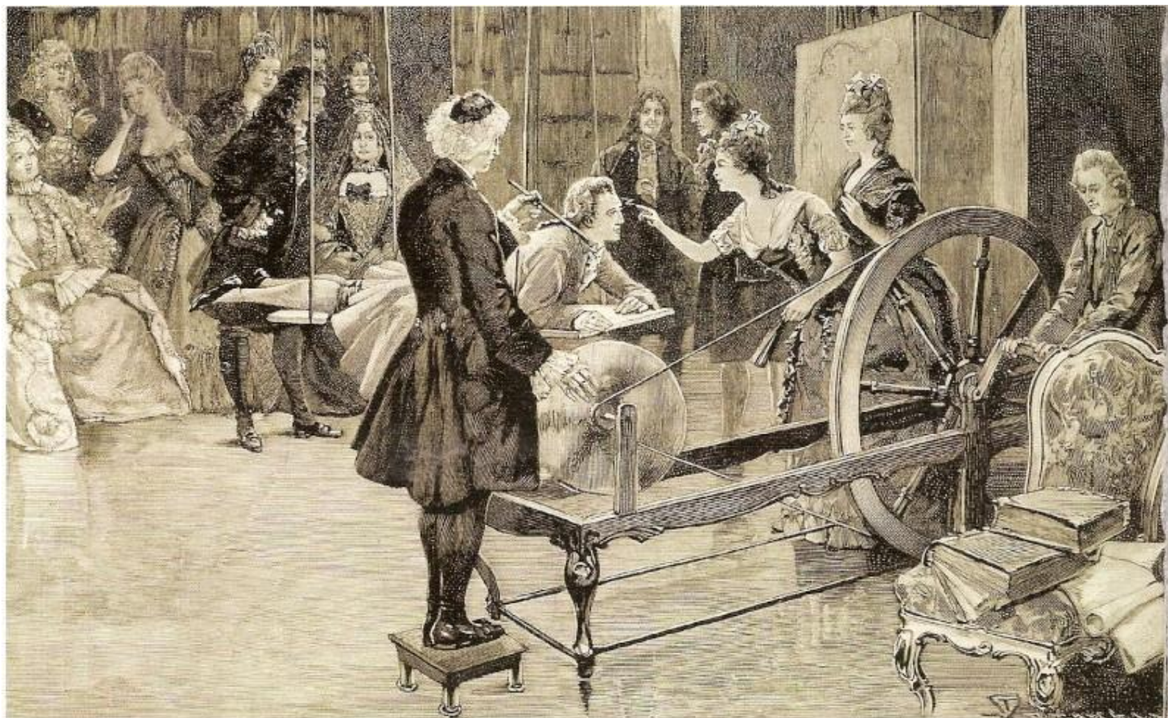
L'abbé Nollet présentait, dans les années 1740, des expériences de physique dans les salons grâce à des machines comportant une roue et un globe de verre qui permettait de générer des phénomènes électriques spectaculaires.
