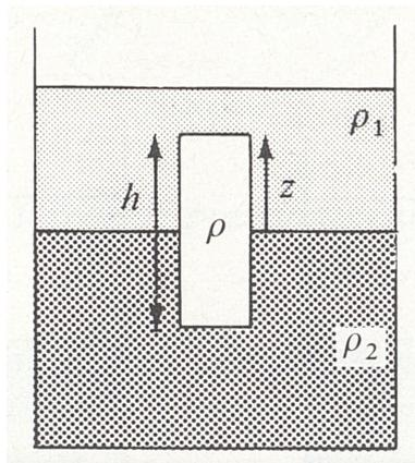
Un solide assimilable à un cylindre de section  $S$  et de hauteur  $h$ , de masse volumique  $\rho$  est immergé dans un récipient contenant deux liquides non miscibles de masses volumiques  $\rho_1$  et  $\rho_2$ .
