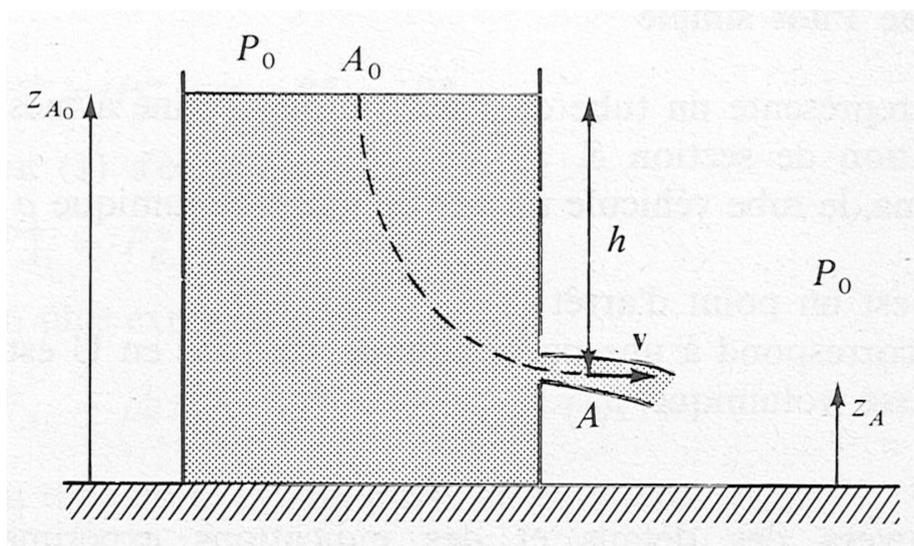
1. Si le trou est très petit, l'écoulement est quasi-stationnaire. En utilisant l'exercice précédent, montrer que la vitesse d'un point de la surface libre est négligeable devant celle du fluide à la sortie.
