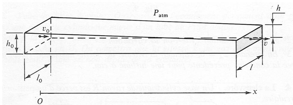
Un long canal (d'axe  $Ox$ ) à fond plat horizontal possède localement une section rectangulaire : autour de la cote  $x$ , sa largeur est  $\ell(x)$ , la hauteur d'eau est  $h(x)$  et la vitesse de l'eau à cet endroit est supposée uniforme valant  $v(x)$ .
