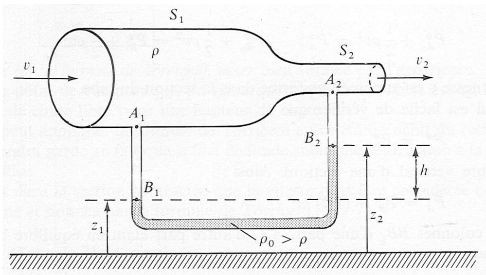
Avec les données de la figure ci-dessus, calculer le débit volumique de l'écoulement en fonction de  $h$ , des sections  $S_1$  et  $S_2$ , et des masses volumiques  $\rho$  et  $\rho_0$ .
